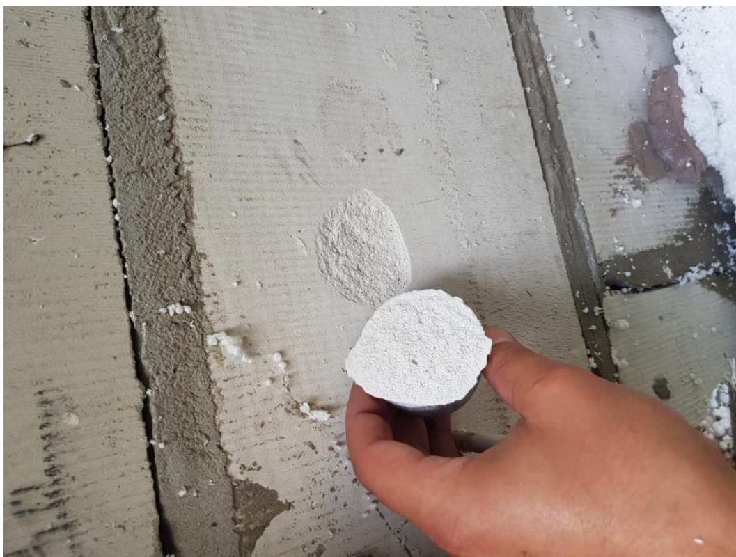
Fot. 35. Widok krążka po badaniu Pull – off; zerwana wierzchnia warstwa pustaka z betonu komórkowego do którego klejono płyty styropianowe; miejsce pomiarowe nr 6
