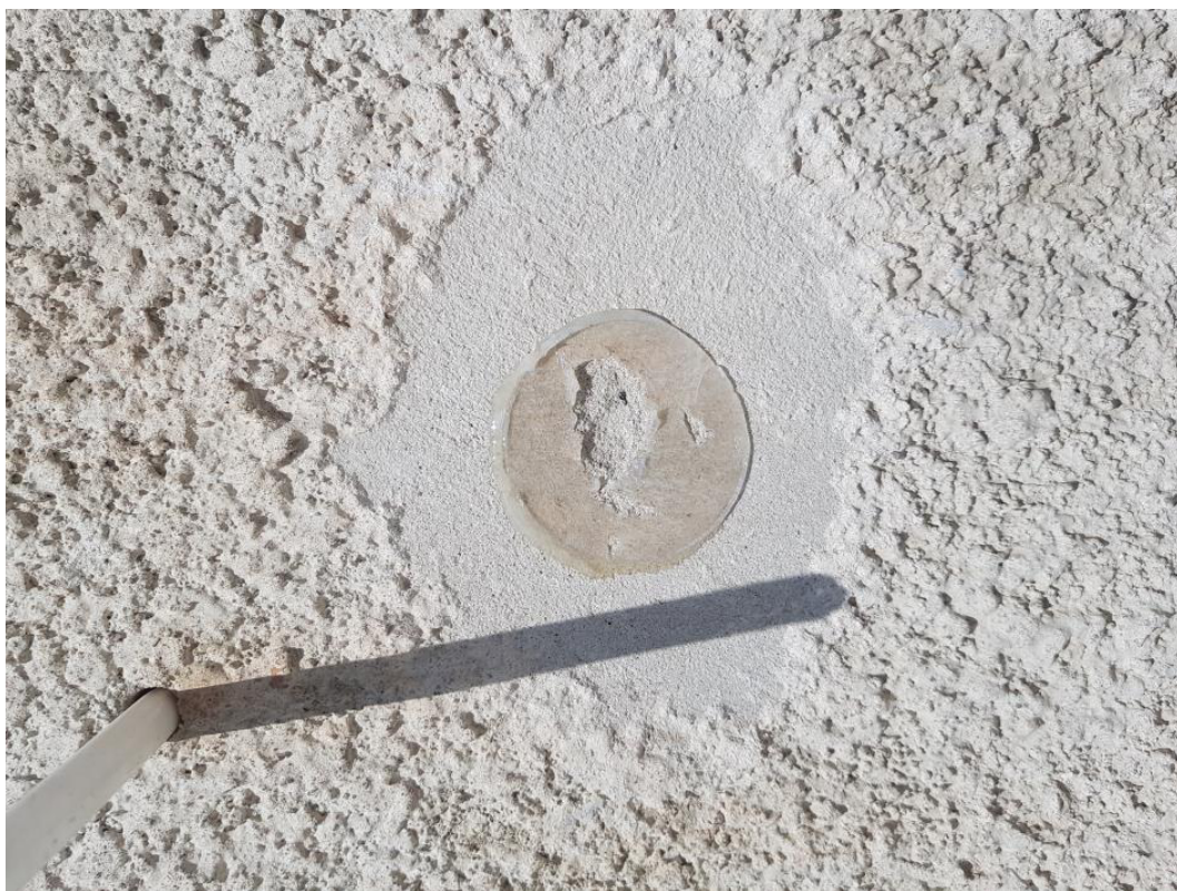
Fot. 31. Miejsce pomiarowe nr 3; zerwanie krążka pomiarowego
