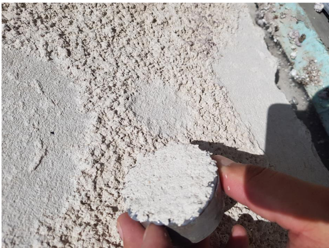
Fot. 32. Widok krążka po badaniu Pull – off; zerwana wierzchnia warstwa tynku do którego klejono płyty styropianowe; miejsce pomiarowe nr 4
