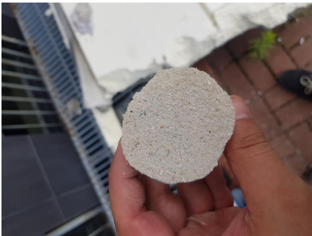
Fot. 28. Widok krążka po badaniu Pull – off; zerwana wierzchnia warstwa tynku do którego klejono płyty styropianowe
