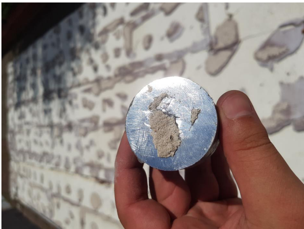
Fot. 30. Silna przyczepność pomiędzy klejem a gładką częścią tynku, zerwanie kleju z krążka
