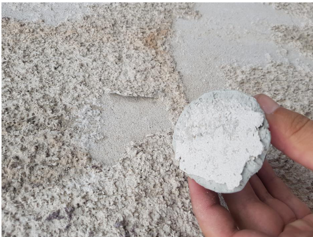
Fot. 33. Widok krążka po badaniu Pull – off; znaczne zerwanie wierzchniej warstwy tynku do którego klejono płyty styropianowe; miejsce pomiarowe nr 5
