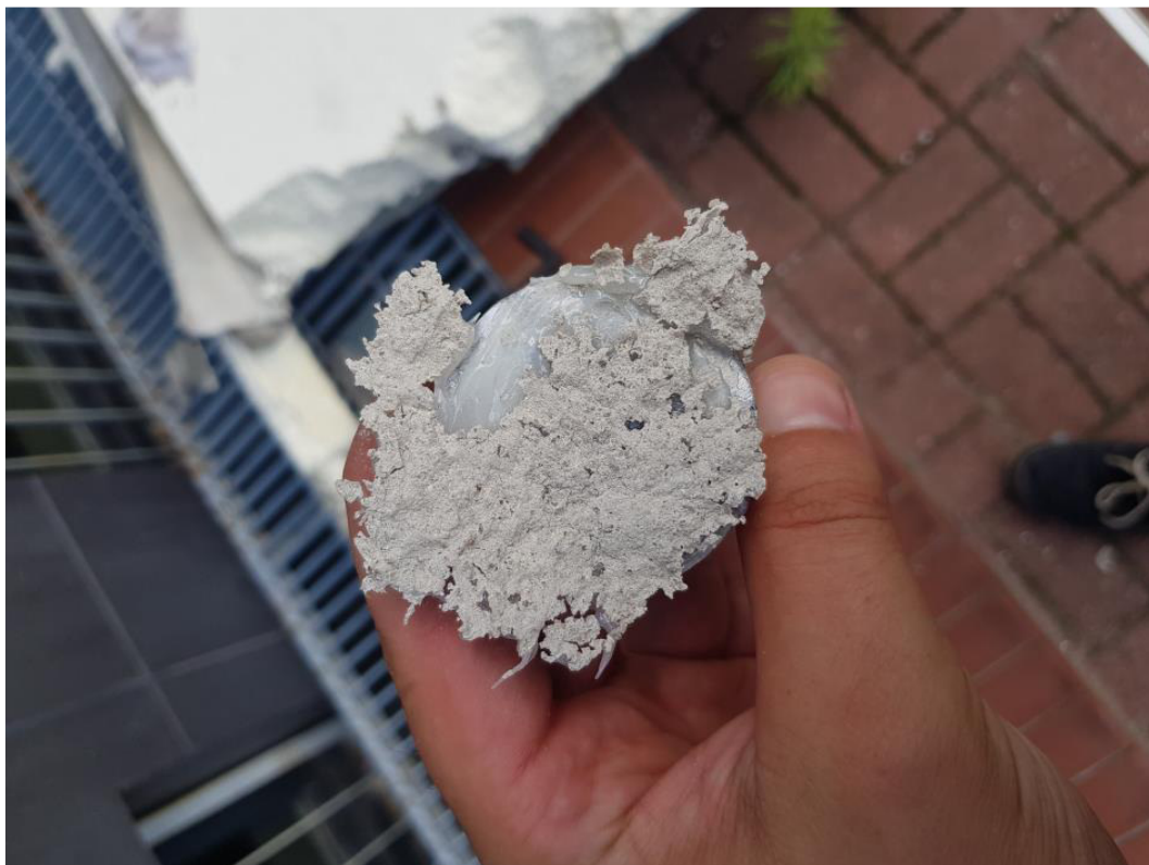
Fot. 26. Widok krążka po badaniu Pull – off; zerwana wierzchnia warstwa tynku do którego klejono płyty styropianowe
