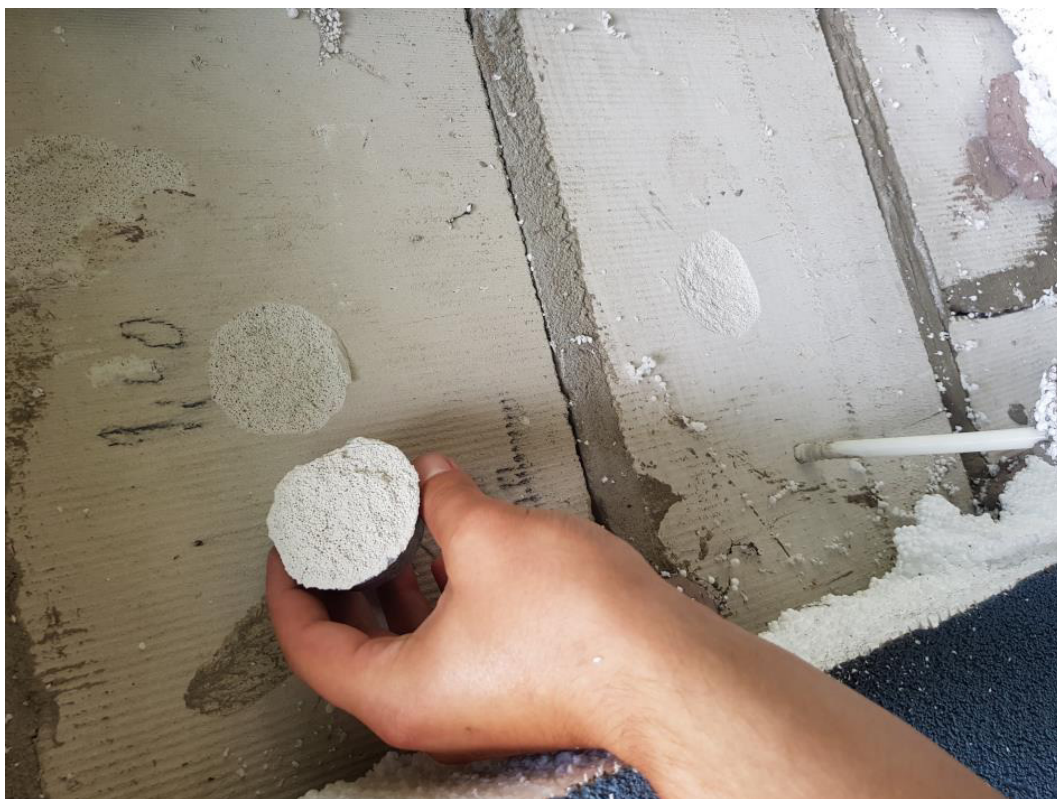
Fot. 36. Widok krążka po badaniu Pull – off; zerwana wierzchnia warstwa pustaka z betonu komórkowego do którego klejono płyty styropianowe; miejsce pomiarowe nr 7
